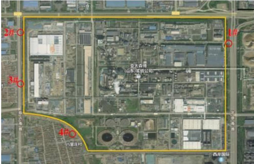
图 7-2 无组织监测布点图(东风)
